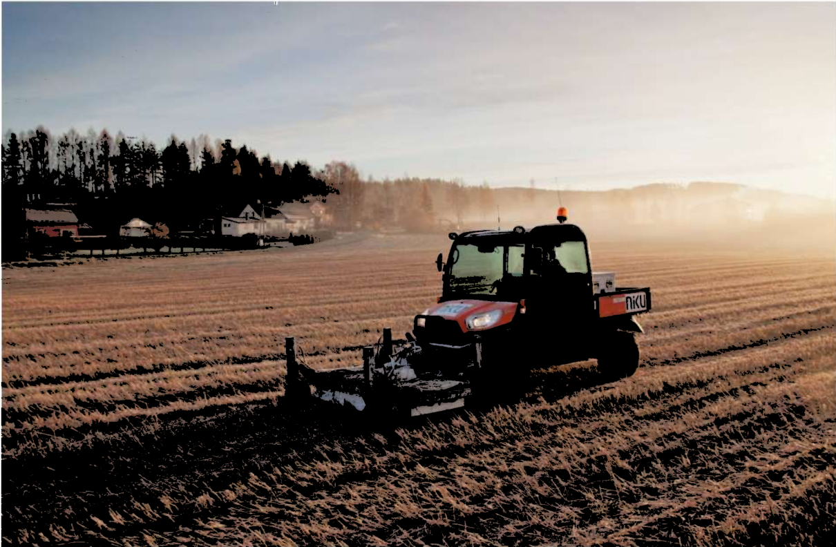
Figur 4 – Georadarsystem av typen MALÅ MIRA III i bruk ved Lundjøret. Foto: LG/NIKU.
